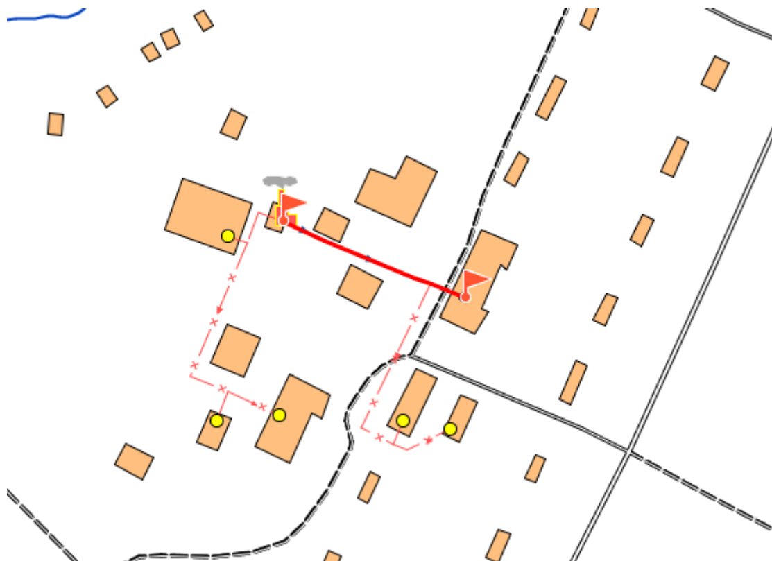
Рис. 10. Путь движения теплоносителя от котельной №6 до конечного потребителя
