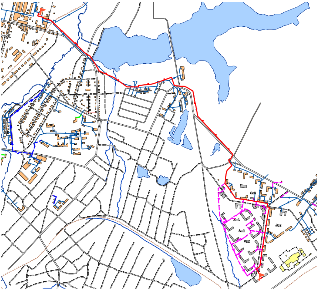
Рис. 23. Путь движения теплоносителя от котельной №25 до конечного потребителя
