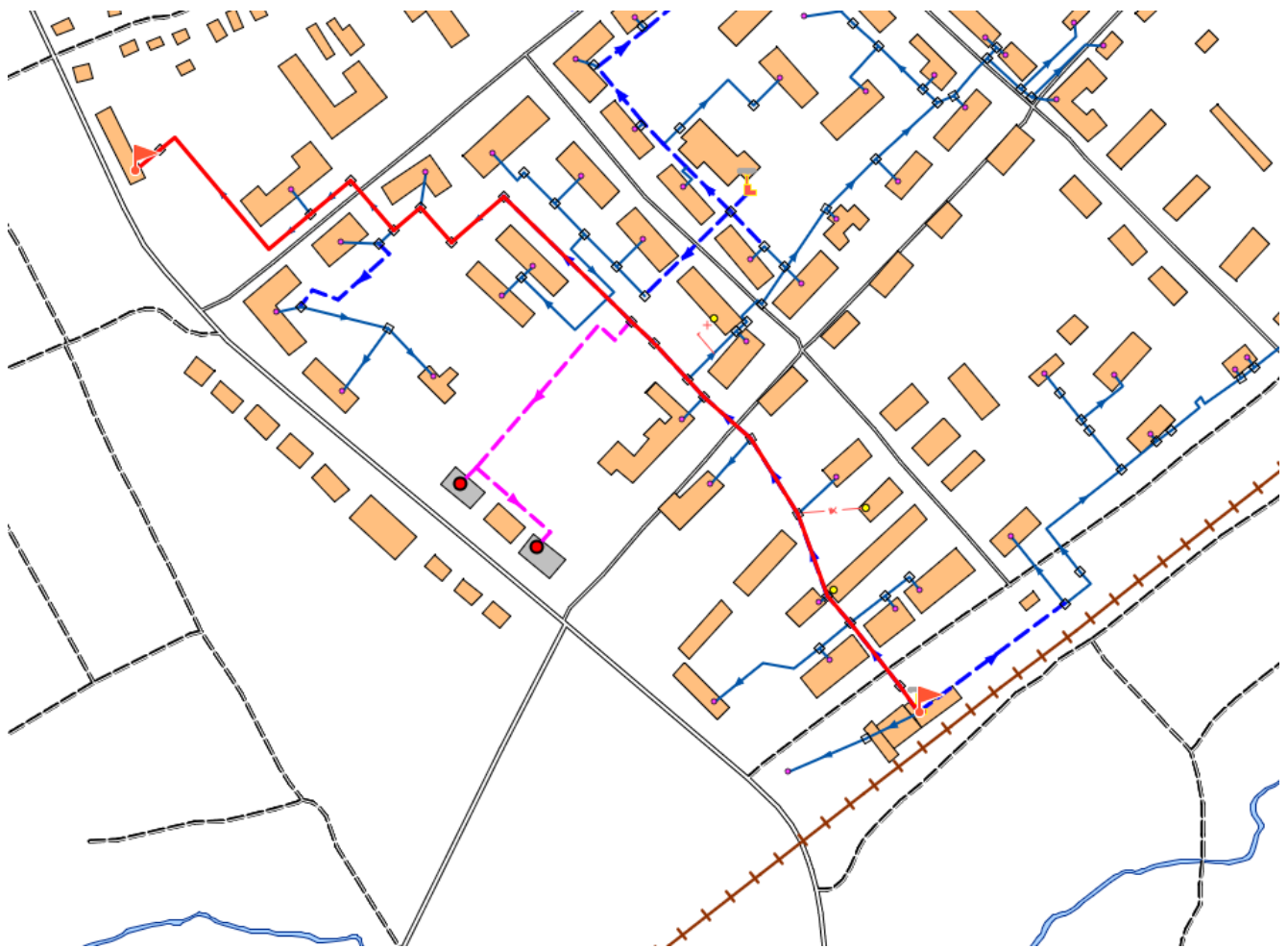
Рис. 12. Путь движения теплоносителя от котельной №8 до конечного потребителя
