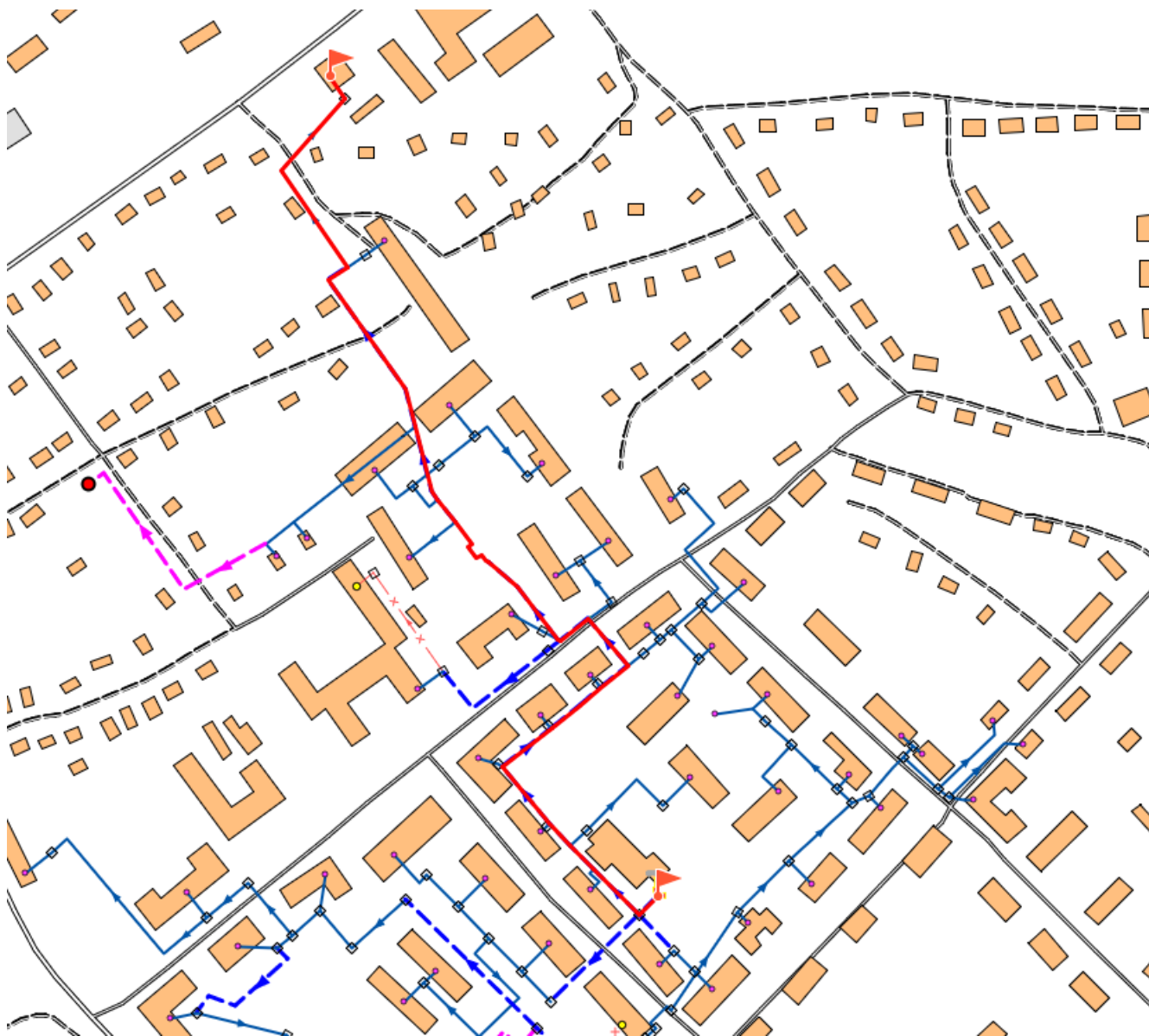
Рис. 11. Путь движения теплоносителя от котельной №7 до конечного потребителя
