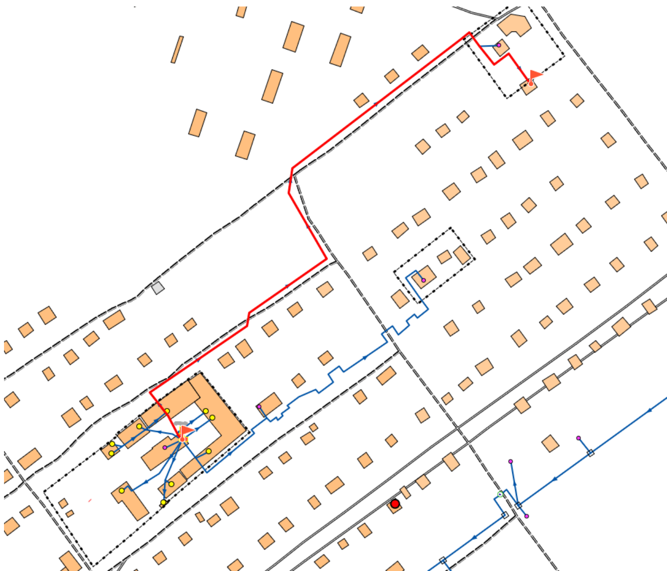
Рис. 27. Путь движения теплоносителя от котельной №30 до конечного потребителя
