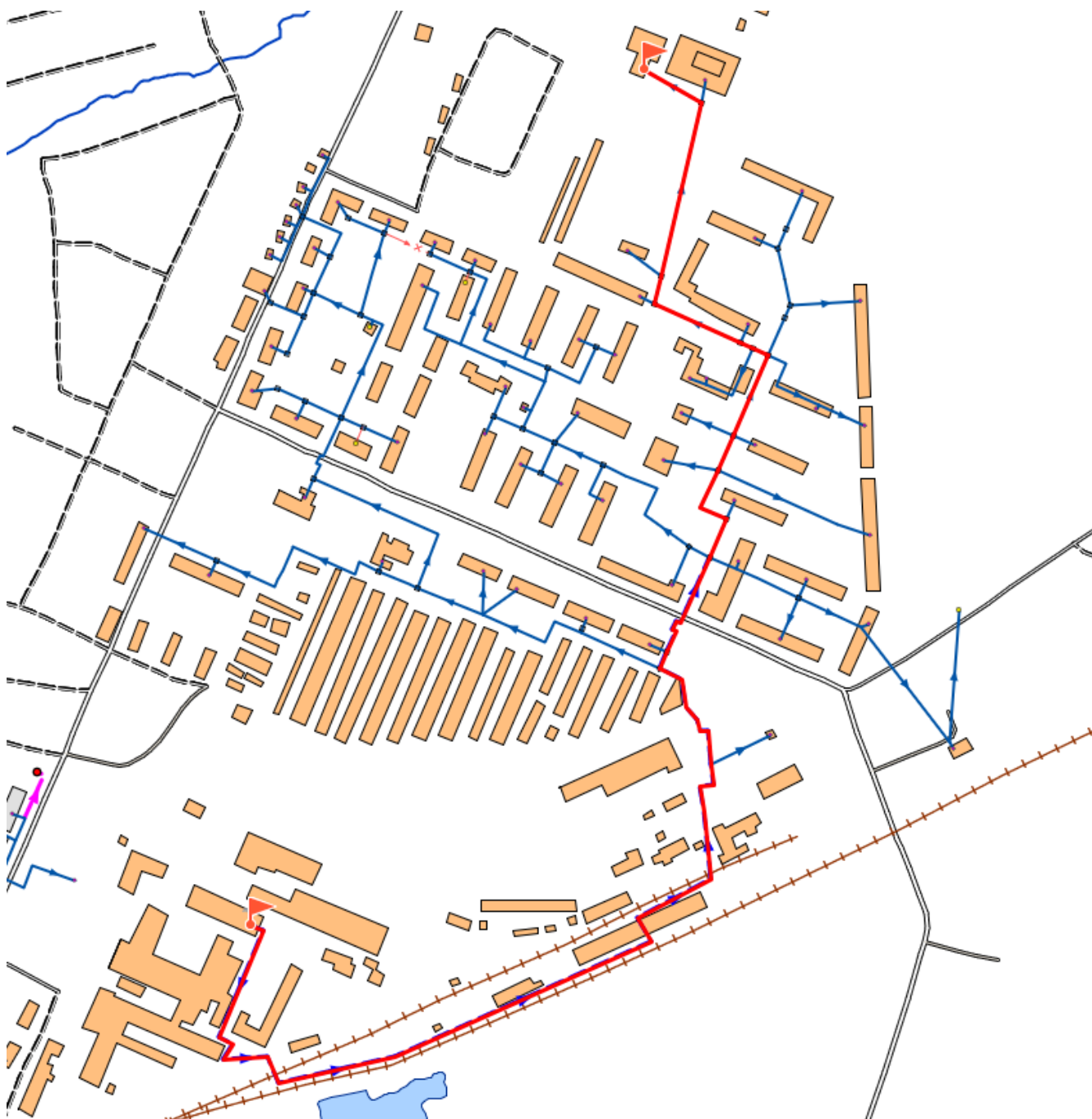
Рис. 6. Путь движения теплоносителя от котельной №1 до конечного потребителя
