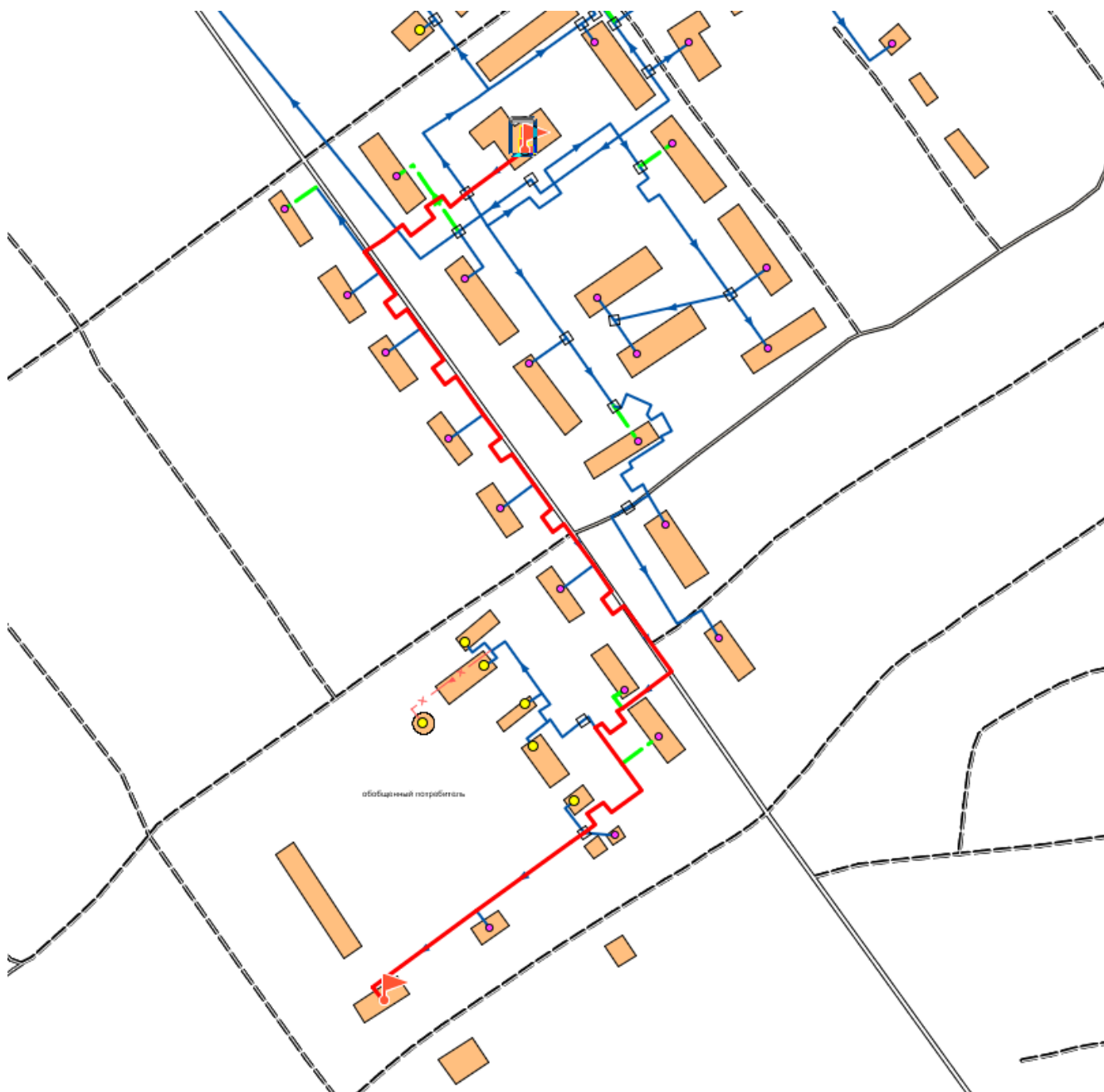
Рис. 18. Путь движения теплоносителя от котельной №18 до конечного потребителя
