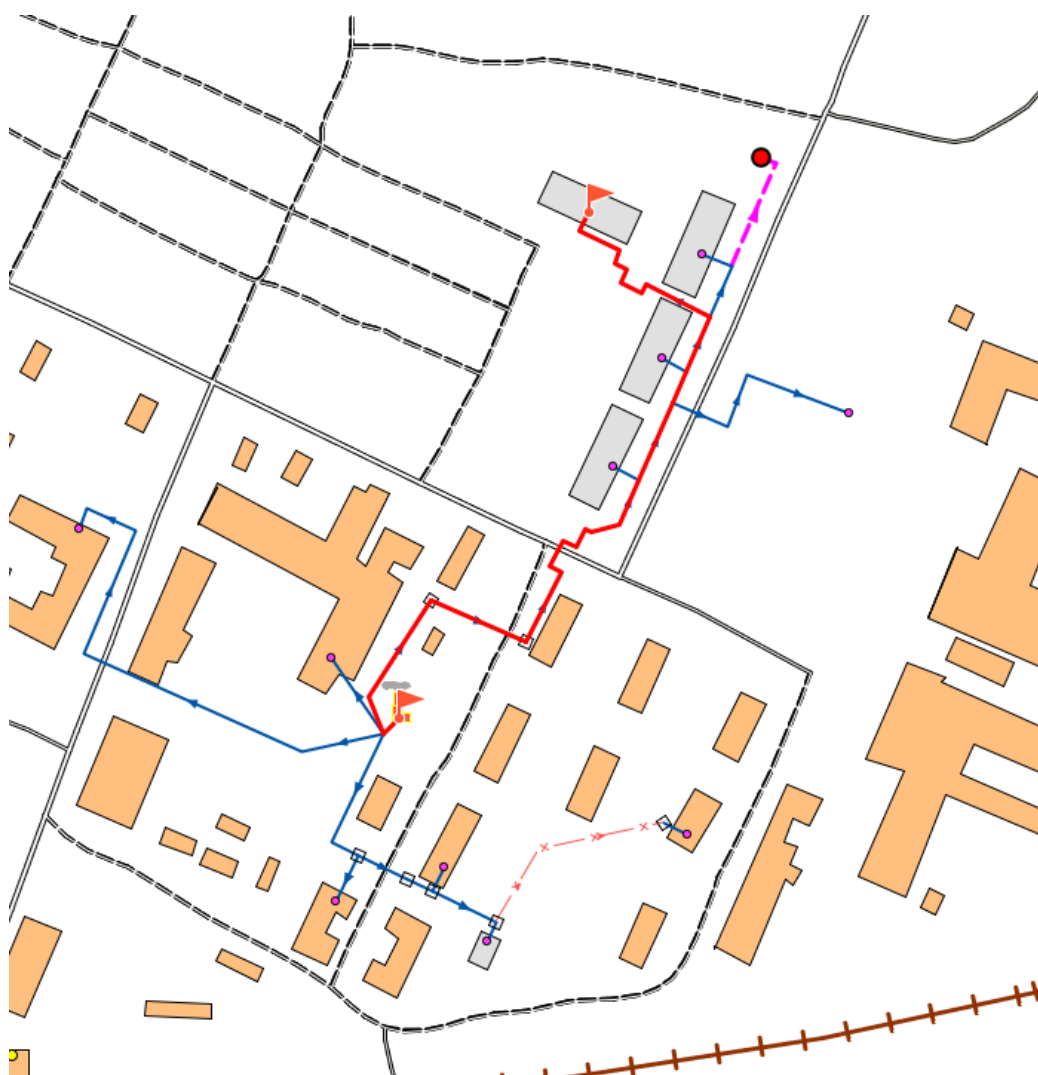
Рис. 8. Путь движения теплоносителя от котельной №4 до конечного потребителя
