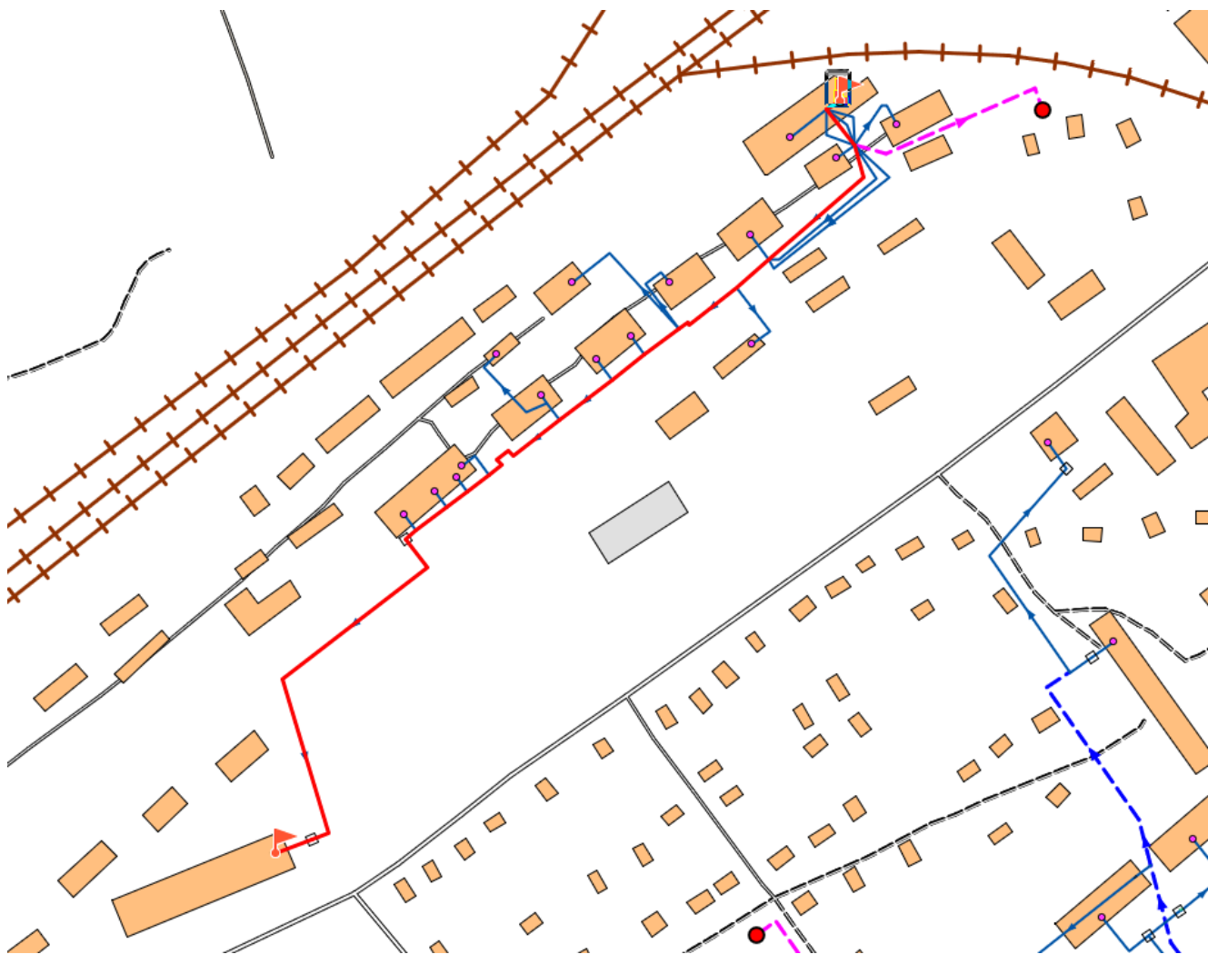
Рис. 24. Путь движения теплоносителя от котельной №26 до конечного потребителя
