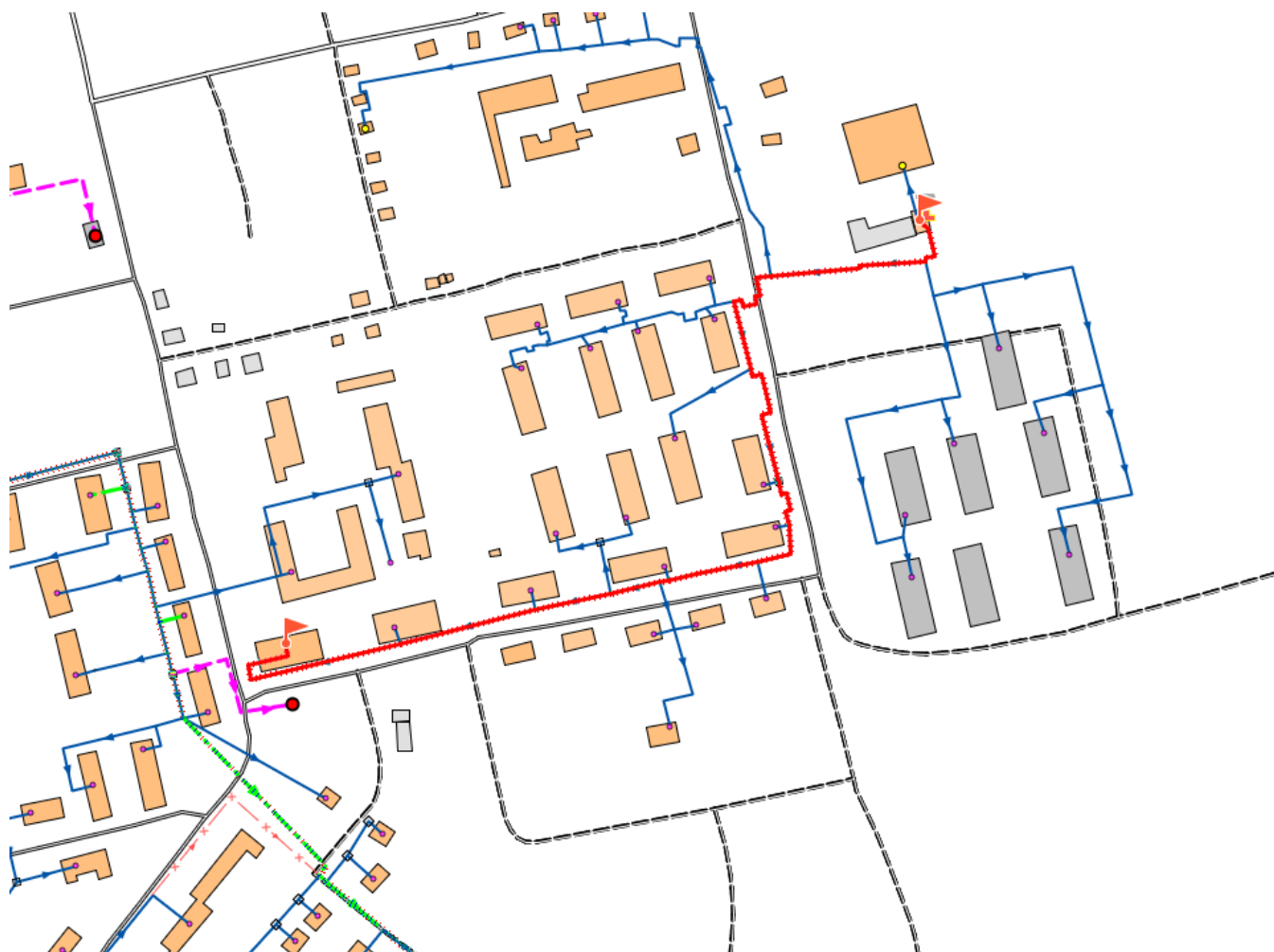
Рис. 17. Путь движения теплоносителя от котельной №16 до конечного потребителя
