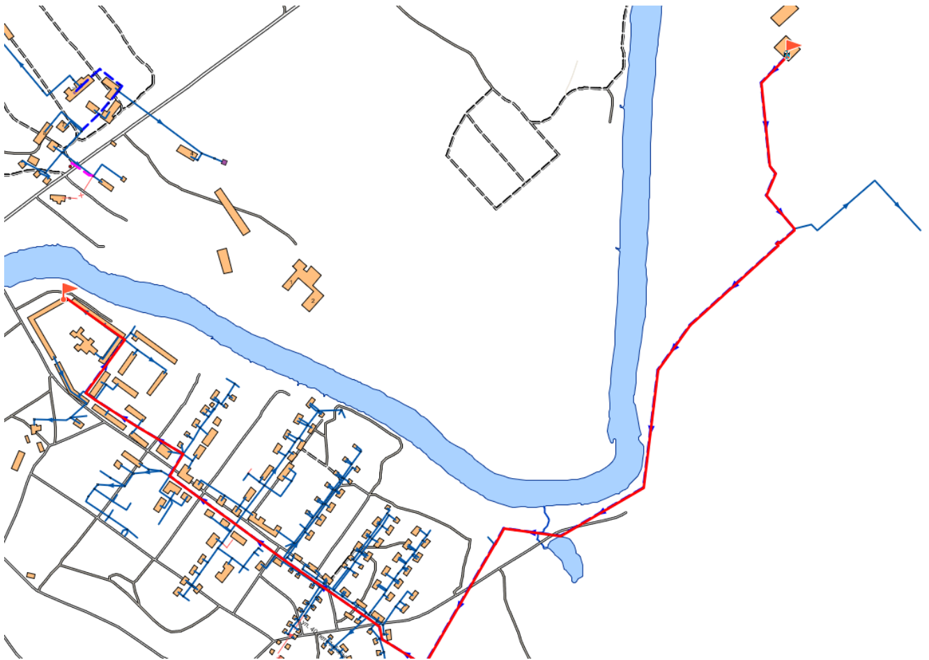
Рис. 15. Путь движения теплоносителя от котельной №14 до конечного потребителя
