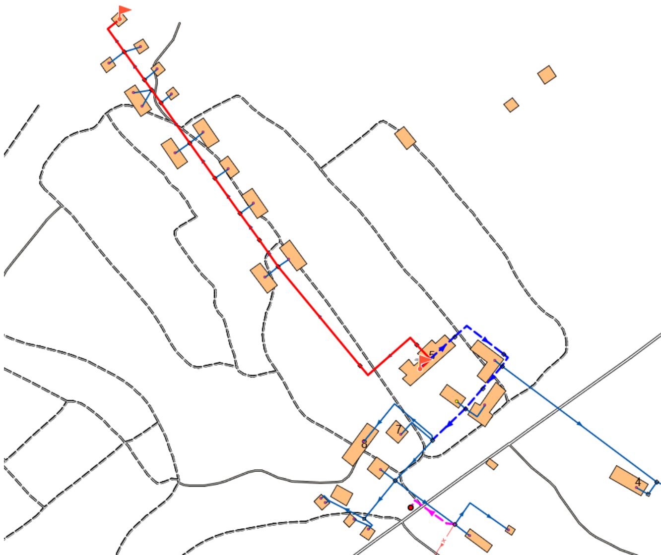
Рис. 16. Путь движения теплоносителя от котельной №15 до конечного потребителя
